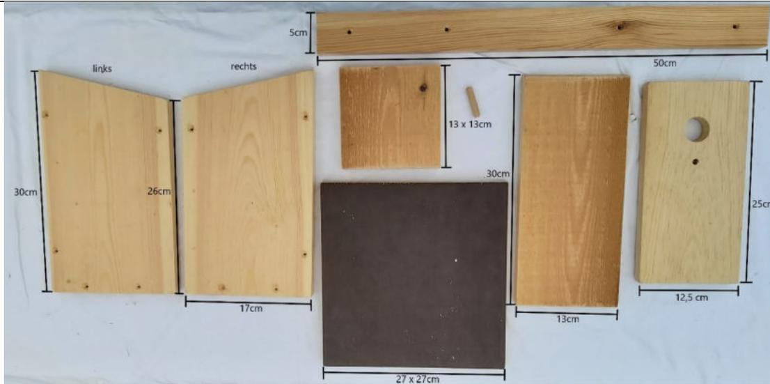
Abbildung 4040: Bestandteile Nistkasten
