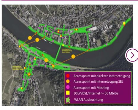
Das durch die Stadt Traben-Trarbach ausgewiesene Areal wird mit bis zu **50 Accesspoints** ausgeleuchtet. Der Ausleuchtungsgrad (grün hervorgehobene Bereiche) beträgt 80%
